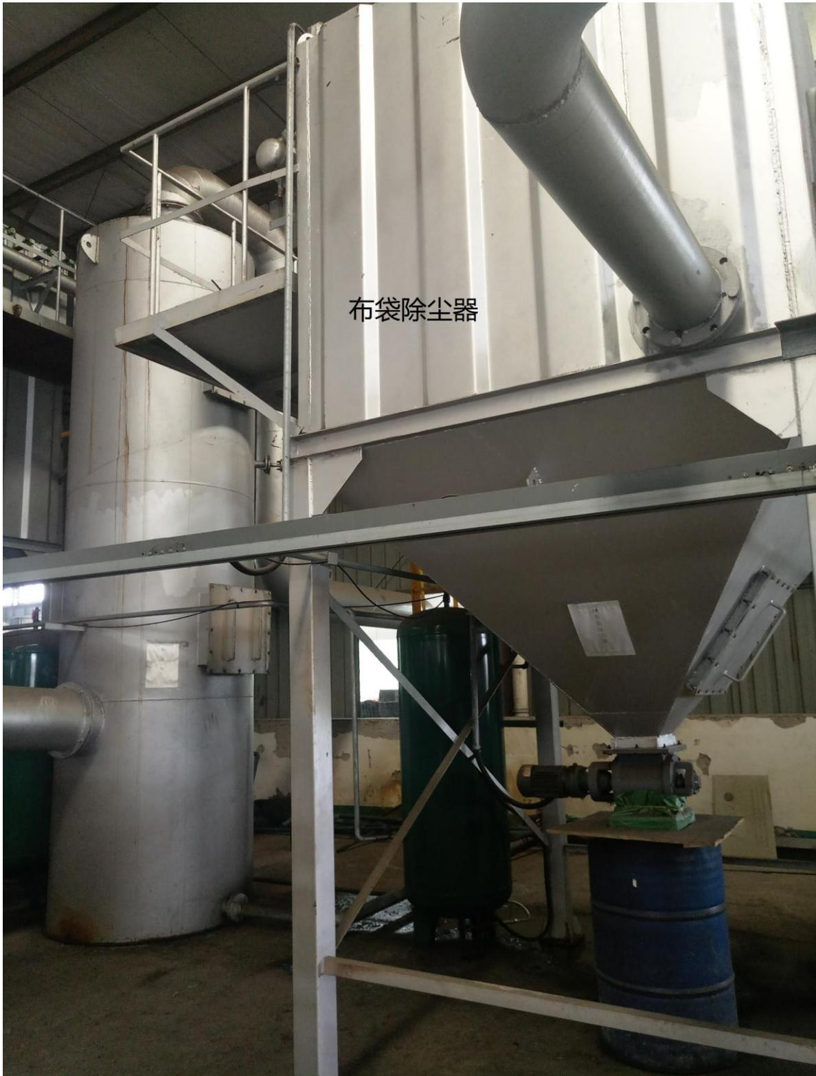
图 4.1-10 吹扫粉尘布袋除尘器
