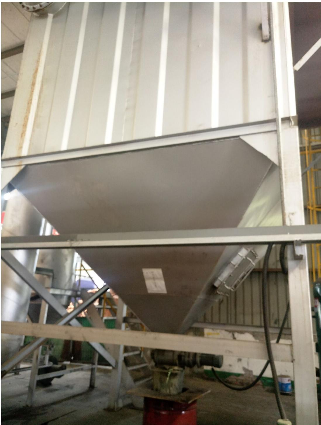
图 4.1-7 热解废气布袋除尘器
