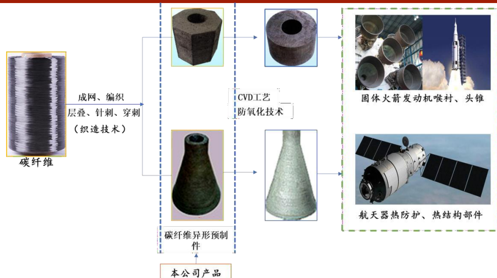
图 33：碳纤维异形预制件在航空航天领域用途示意图
