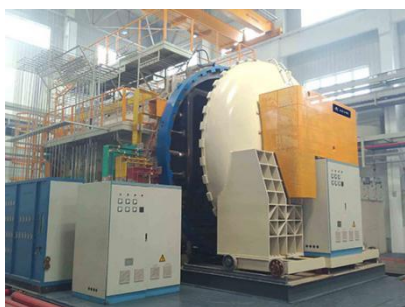
化学气相沉积炉
