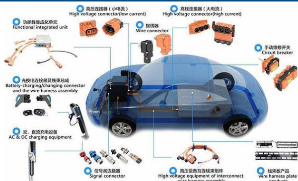
图表21： 连接器在新能源汽车上的应用
