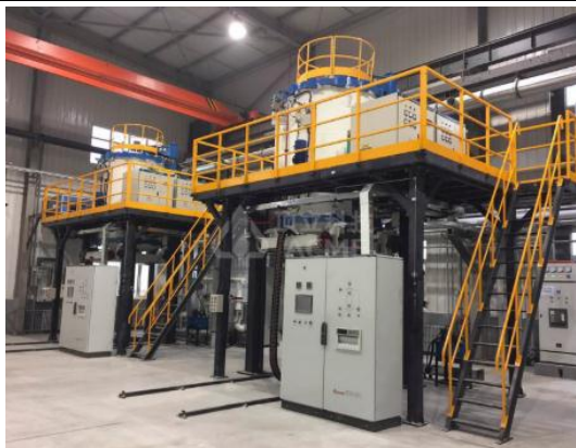
图表24： 顶立科技生产的立式真空石墨化炉
