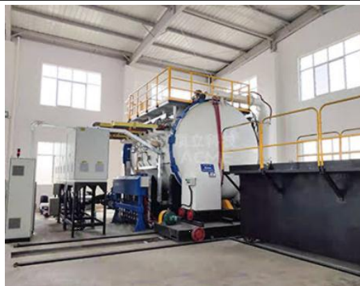
图表25： 顶立科技生产的卧式真空石墨化炉
