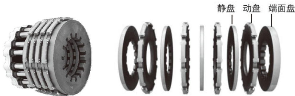
图表27： 飞机碳碳复合材料刹车盘结构
