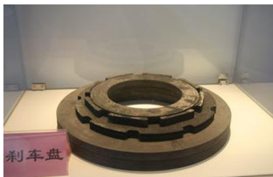
图表28： 北摩高科生产的碳碳复合材料刹车盘
