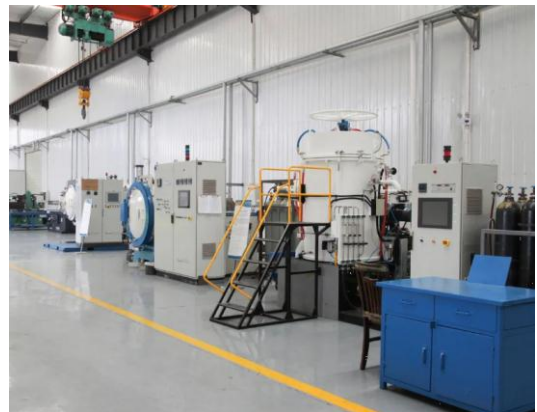
图表47： 顶立科技 3D 打印后续热处理设备
